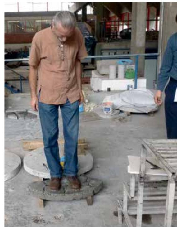
Figura 45. Verificación de la efectividad de la unión entre fragmentos de concreto simple.
