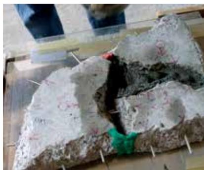
Figura 43. Evaluación en laboratorio de la solución propuesta para reintegrar los fragmentos de mortero. En fragmentos de una placa de concreto simple se incrustaron pernos de acero inoxidable para lograr una integración mecánica entre ellos y entre los mismos fragmentos y el mortero añadido.
