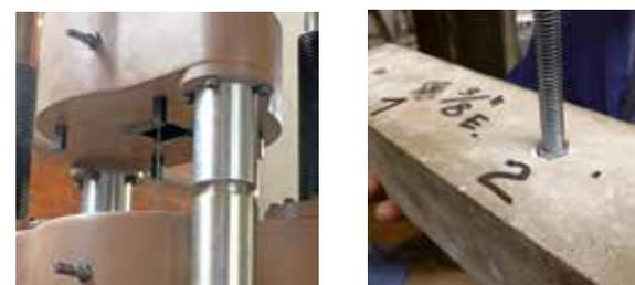
Figura 41. Prueba de laboratorio para corroborar la resistencia de pernos y taquetes instalados sobre una pieza de concreto simple.
