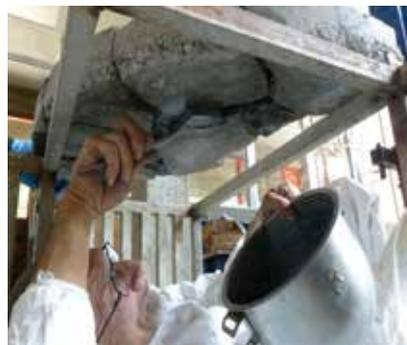
Figura 44. Aplicación de mortero entre los fragmentos de una placa de concreto simple simulando condiciones de aplicación similares a las que se enfrentarían en la rehabilitación del mural.
