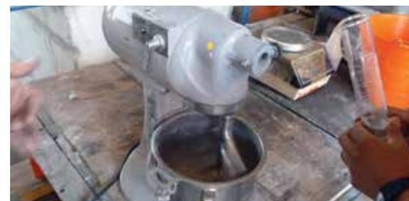
Figura 42. Corroboración en laboratorio del mismo mortero que se utilizó para rehabilitar el plafón.
