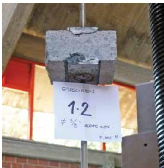
Figura 40. Prueba de laboratorio para determinar la capacidad por adherencia de la misma resina que se utilizó para la sujeción del plafón al bastidor.
