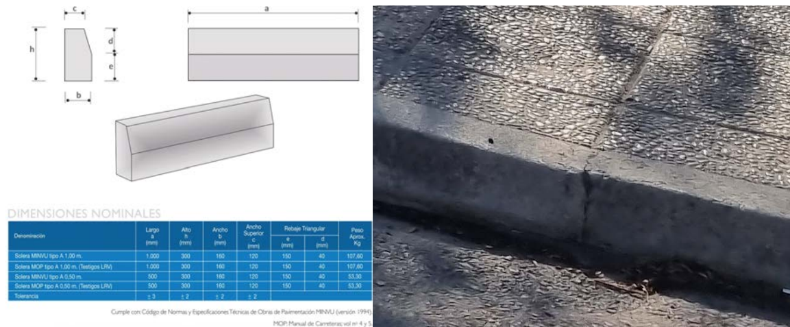
Figura 9. (izquierda) Planimetría y (derecha) fotografía de la solera MINVU. Fuente: GRAU (2023); y Archivo ONG Poloc 2023, respectivamente.
