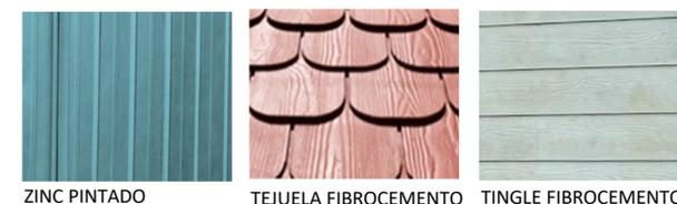
Materiales para revestimiento de muro de fachada.
