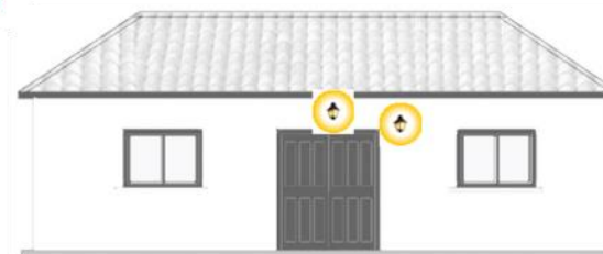
Luminarias en esquina de vanos
