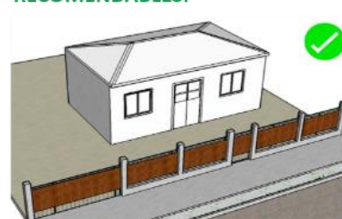
CIERRES EN REJA METÁLICA CON ENTABLADO DE MADERA VERTICAL
