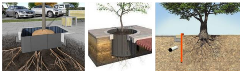
Barreras de conducción de raíces
