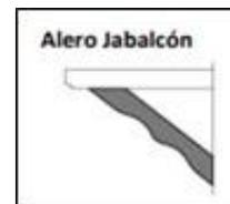
**B.2. Alero Jabalcón:** Elemento estructural de madera, inserto diagonalmente en el plano de fachadas, cuyo objetivo es reforzar la armazón de una cubierta, alero o balcón. Pueden ser rectos o arqueados.
