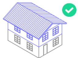
Mantiene la composición de la cubierta a dos o cuatro aguas
