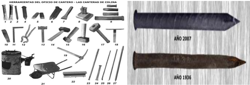
Pie de figura. Herramientas para el trabajo en piedra del Pueblo de las Canteras y el cambio de una de ellas. Fuente: Garcés, 2008.
