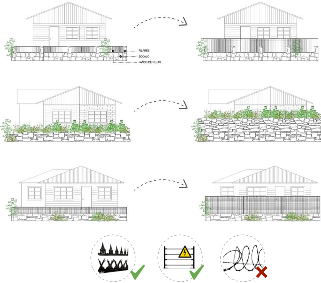
Pie de figura. Indica ejemplo para cierros perimetrales en la ZT. Fuente: ST CMN, 2024.
