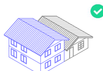
Ampliación en altura adosada hacia los costados
