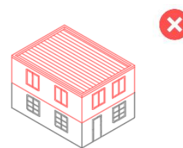
Ampliación que modifica la morfología de la cubierta
