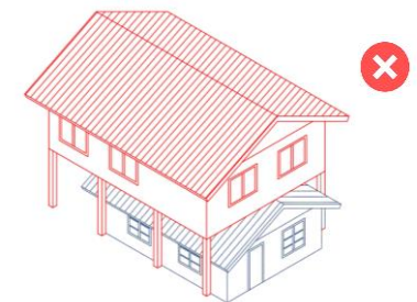
Obra nueva que afecta a la morfología de la construcción original
