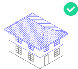
Ampliación en altura por la misma línea de construcción
