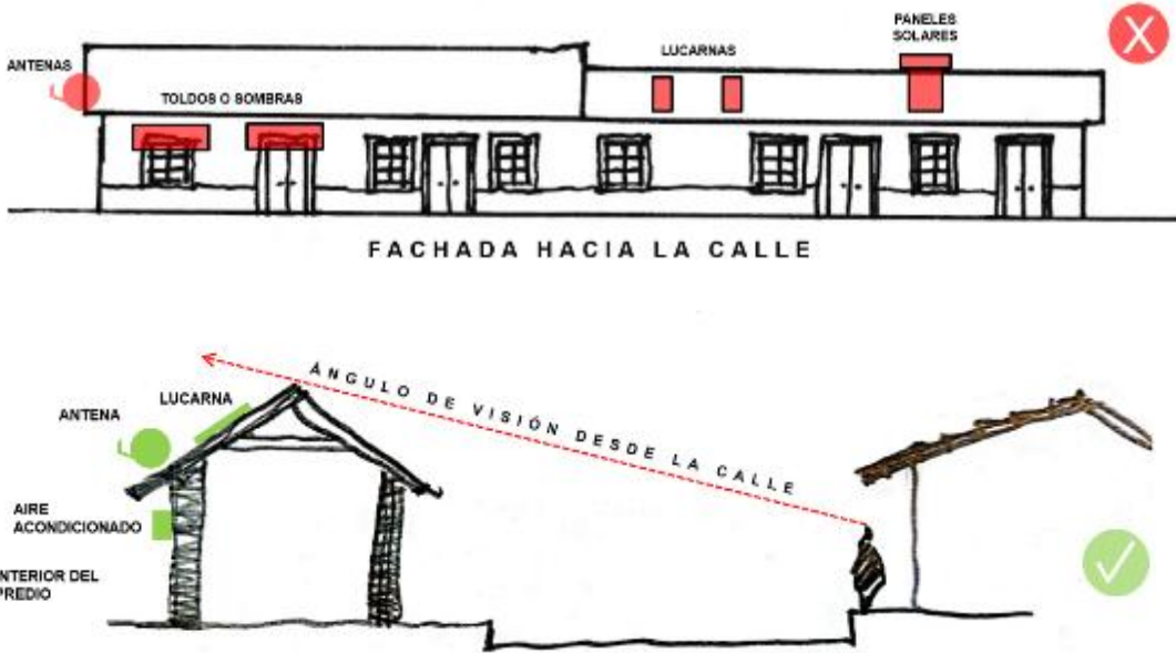
Figura 82. Se debe evitar la instalación de cualquier elemento que distorsione la imagen de las fachadas principales de los inmuebles hacia la vía pública.
