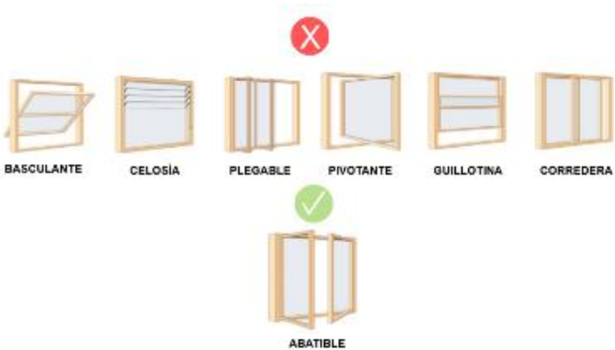
Figura 73. Ventanas abatibles de madera es el único tipo a utilizar en fachadas hacia la calle.
