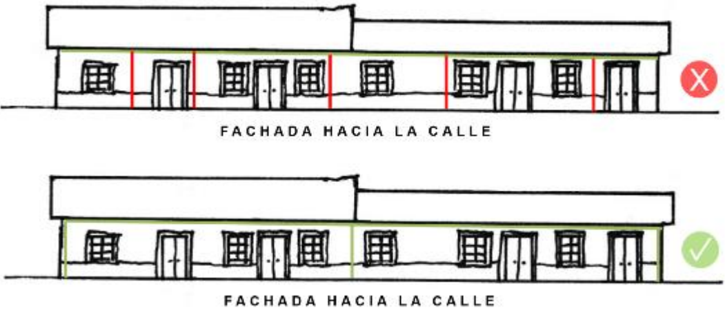
Figura 81. Instalación de canaletas y bajadas de agua, ubicadas en los bordes de la fachada y ojalá en una mínima cantidad (el mismo principio se recomienda para la instalación de cableados de electricidad, telefonía y TV).
