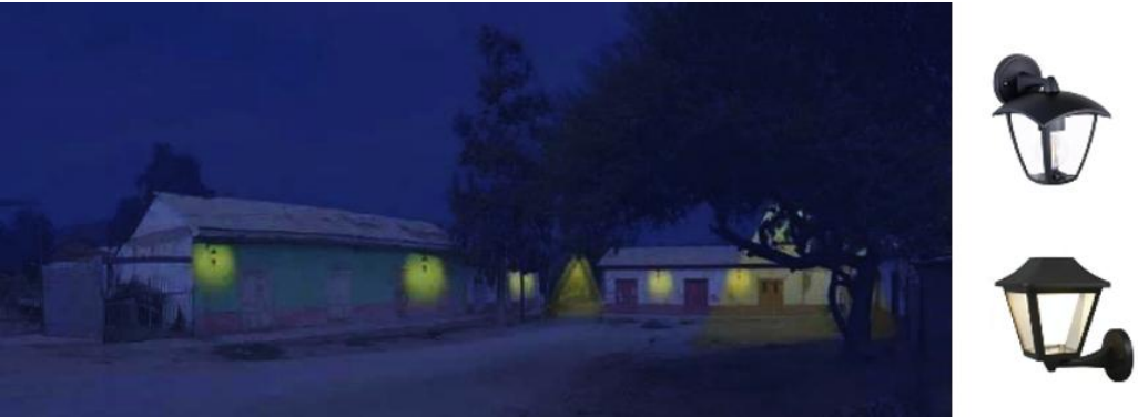
Figura 79. En caso de requerir iluminación hacia la vía pública, se recomienda el uso de faroles anclados al muro de fachada ubicados en las esquinas de vanos o espacios centrales de la fachada.
