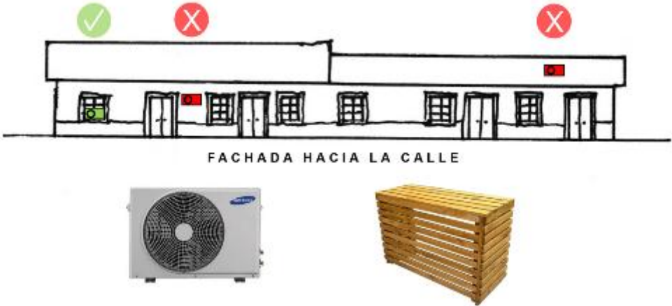
Figura 83. Sistemas de aire acondicionado deberían ser instalados integrados a los vanos existentes, sin interferir en planos de muros ni cubiertas.
