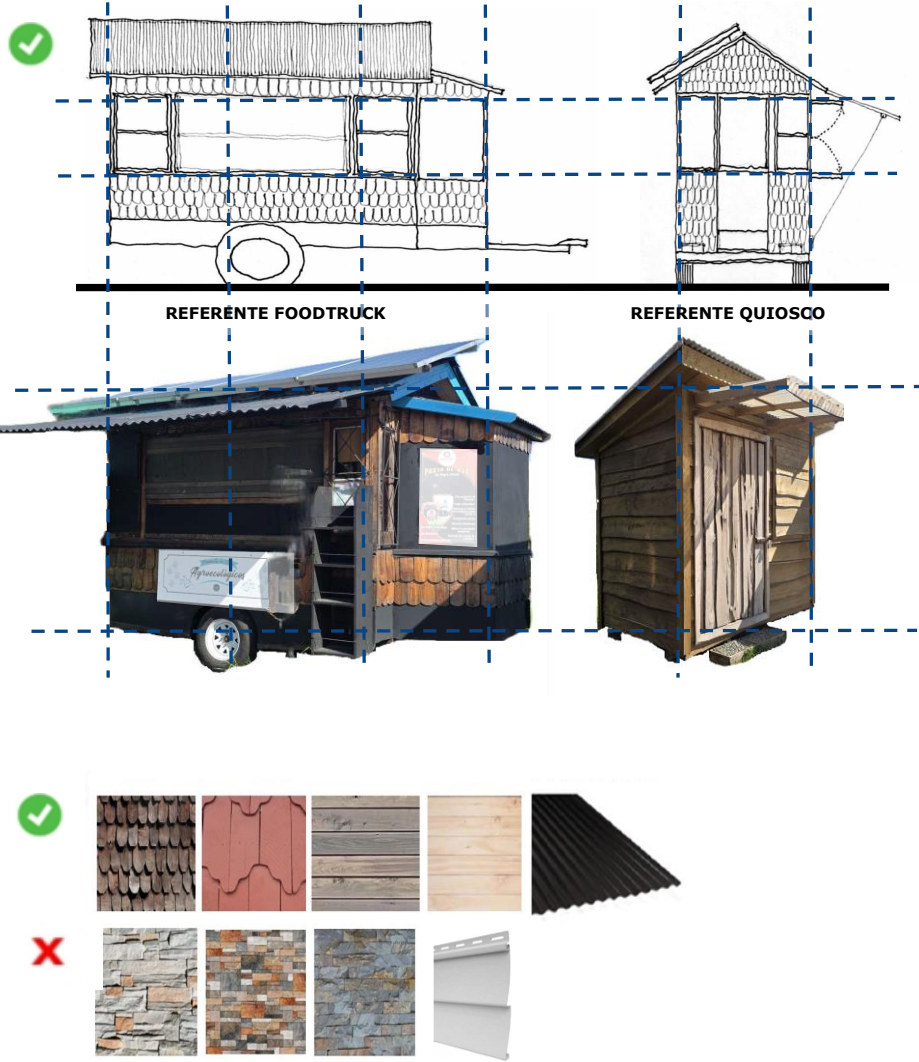
Imagen 82. Esquema de la composición de fachada, materialidad y sistema constructivo para quioscos y carros o foodtrucks. Fuente: Elaboración propia OTP Chiloe, 2025.
