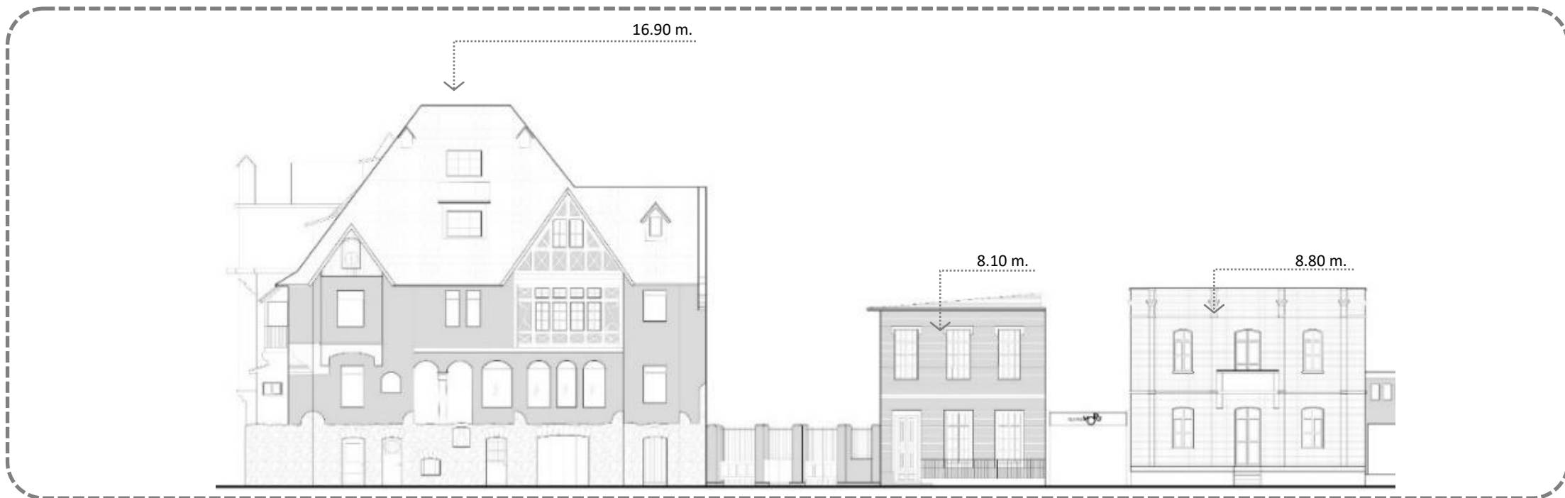
Fig. 173: Alturas aproximadas existentes en inmuebles del sector norte. Fuente: Consultora Mireya Danilo (Equipo: Mireya Danilo, Cristina Briño y Fernando Navarro).
