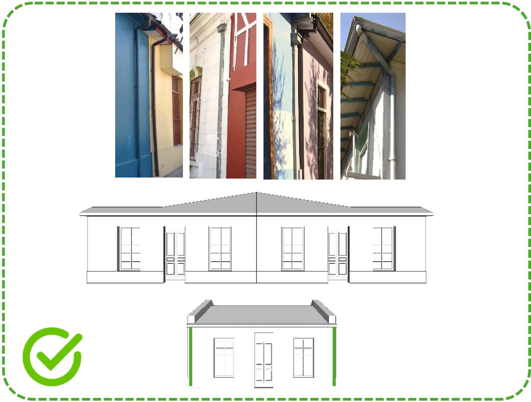
Fig. 275: Posible ubicación de bajada de aguas lluvias en fachada. Fuente: Consultora Mireya Danilo (Equipo: Mireya Danilo, Cristina Briño y Fernando Navarro).
