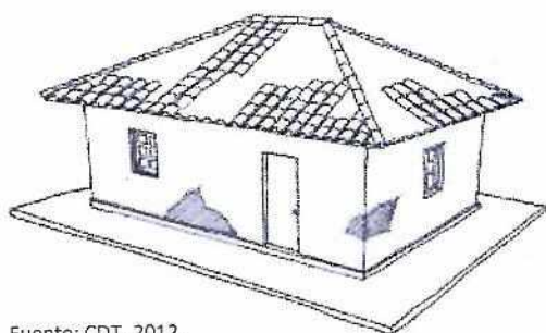
Desprendimiento de estucos
